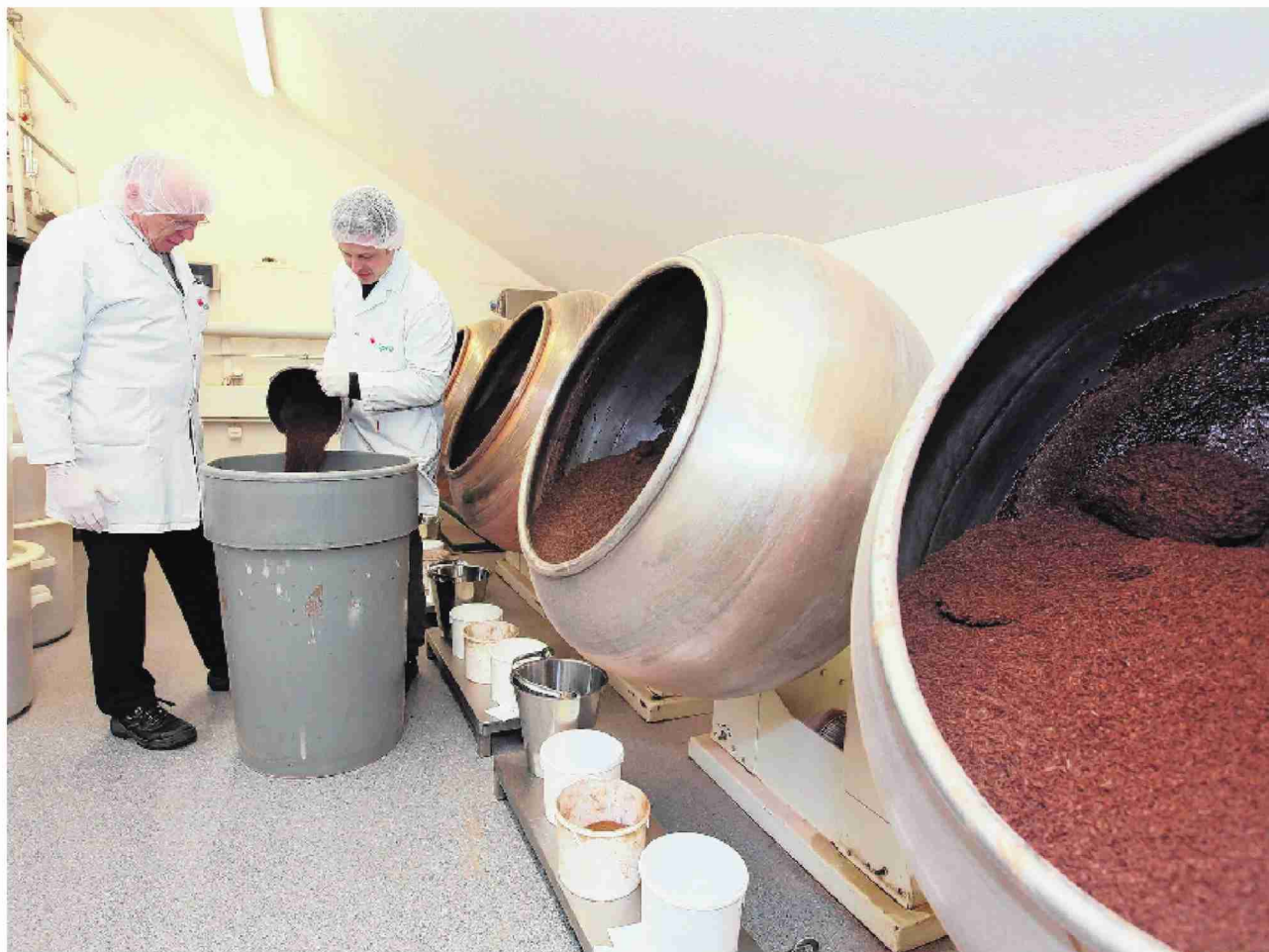
Komplexe Schokostreuselproduktion: Koni Wälchli (links) mit Sohn und Nachfolger Marcel im Reich der Dragiertrommeln. Bild: Nicolas Zovni
