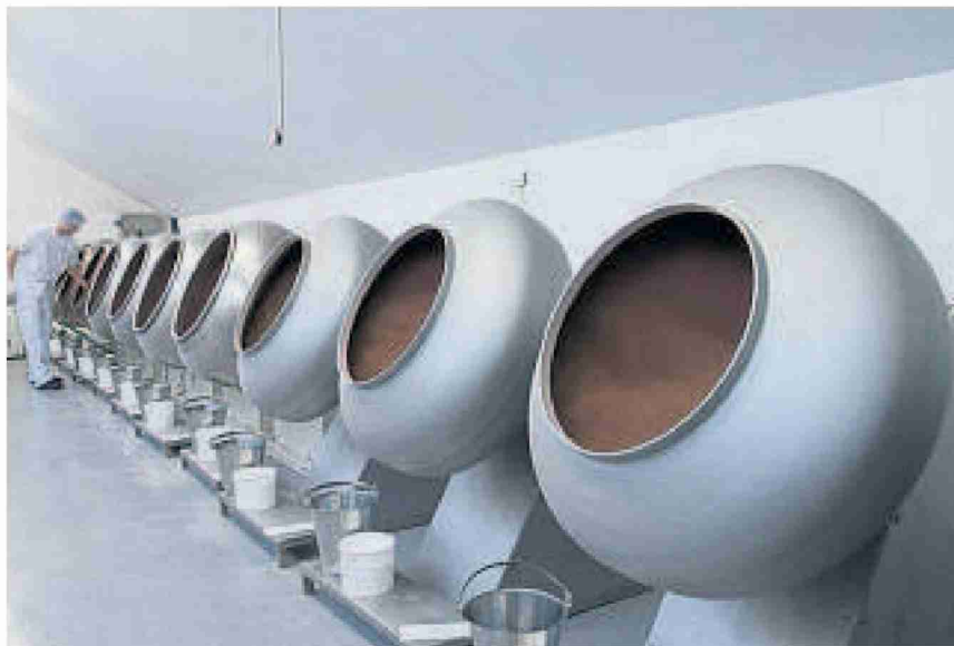
Die Streusel werden 3 bis 6 Stunden lang in Trommeln ummantelt.
